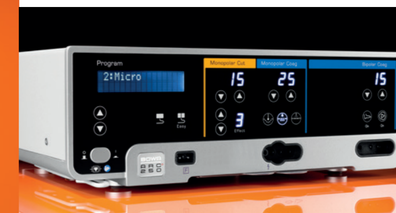
В программе Micro для использования электродов-микроигл применяются точно регулируемые токи.
